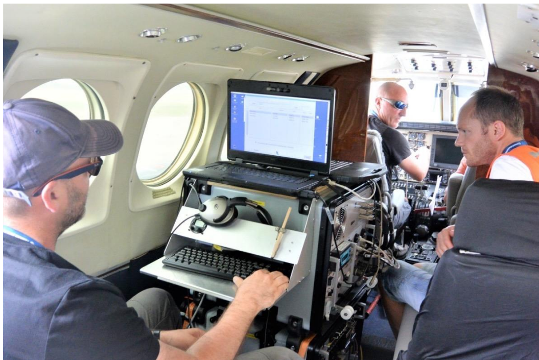
Vue à l'intérieur de l'avion lors des manœuvres de calibration de l'ILS et du Contrôle des DVOR/DME.
