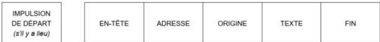
**Figure 4-2. Forme de transmission — Exploitation par téléimprimeurs (cf. 4.4.10.1.2)**
